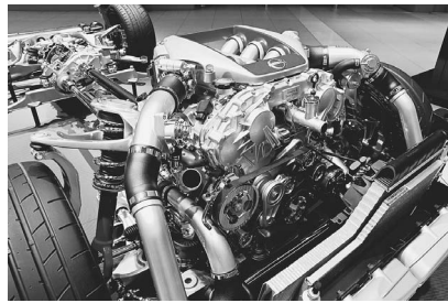
8リットルのV6エンジンは職人の手で組み上げられる
