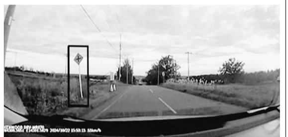
傾いた標識を検出した様子(写真内黒枠部分)
