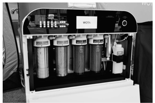
4本のフィルターを通して水が循環する
