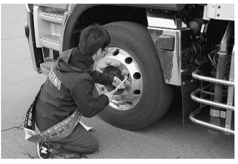
打検でナットのゆるみを確認
